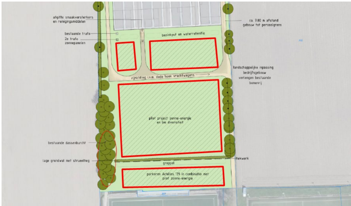
Figuur 3.4 Variant zonnepanelen op het achterterrein
